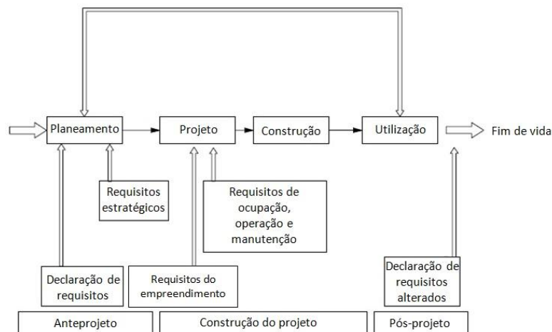
Figura 3.3 – Requisitos ao longo do ciclo de vida (adaptado de ISO 2008a)
